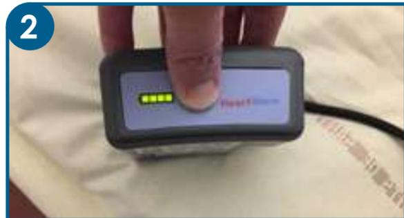
2 Vérifier le niveau de charge en appuyant sur le témoin de la batterie.
