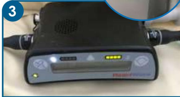
3 Déverrouiller le câble du secteur en tournant la bague du connecteur relié au contrôleur.
