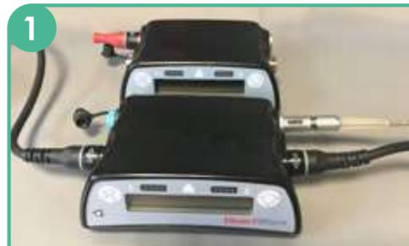
Placer le contrôleur de secours dans la même position que le contrôleur défectueux.
