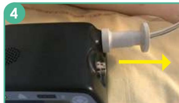
Retirer le capuchon blanc de la ligne de transmission du contrôleur défectueux (câble reliant le contrôleur à la pompe).
