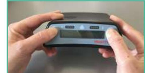
Si le bouchon d'alarme n'est pas disponible, maintenir enfoncés les boutons d'arrêt d'alarme et de défilement sur le contrôleur d'origine pendant au moins 5 secondes puis relâcher les boutons d'arrêt d'alarme et de défilement.
