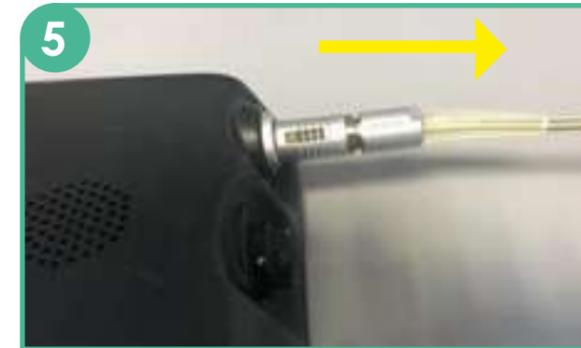
Déconnecter la ligne de transmission du contrôleur défectueux en effectuant une légère pression sur la partie striée entre le pouce et l'index et en tirant.
