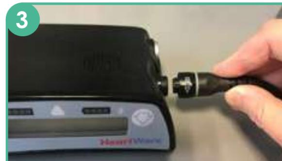
Connecter cette batterie sur le contrôleur de secours en alignant la flèche blanche sur le point rouge jusqu'au clic.
