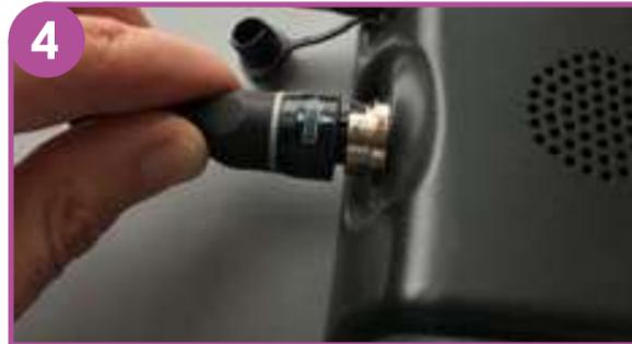
4 Connecter la nouvelle batterie en alignant la flèche blanche avec le point rouge jusqu'au clic.
