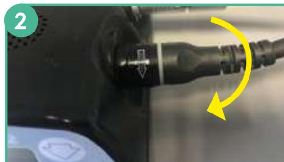
Déconnecter une batterie du contrôleur défectueux en tournant la bague légèrement puis en tirant.
