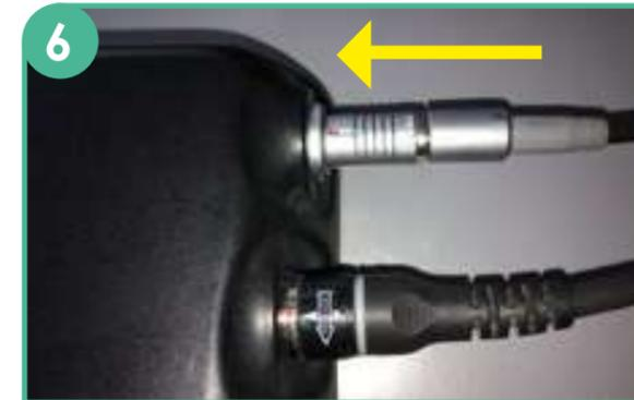
La connecter rapidement sur le contrôleur de secours en mettant les repères rouges face à face et en poussant.
