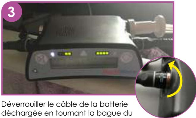
3 Déverrouiller le câble de la batterie déchargée en tournant la bague du connecteur relié au contrôleur.
