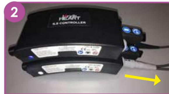
2 Déconnecter le câble gris (en Y) du contrôleur primaire et le connecter au contrôleur de secours.
