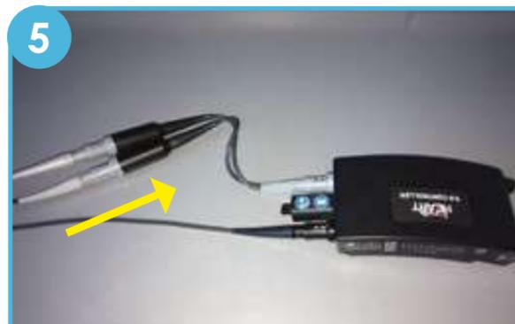
5 Brancher l'embout gris du câble relié à l'une des batteries prévues pour la nuit sur l'extrémité libre du câble en Y.
