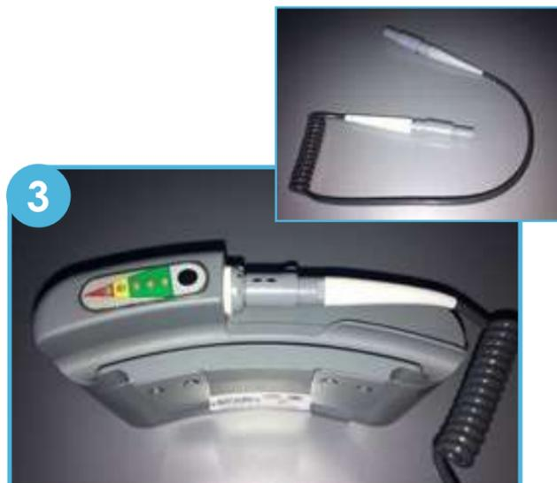
3 Prendre 2 câbles simples et connecter les embouts gris et blanc sur chacune des batteries.
