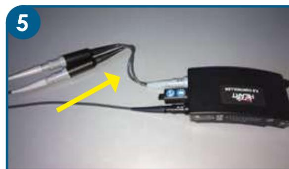
5 Brancher l'embout gris du câble relié à la batterie sur l'extrémité libre du câble en Y.
