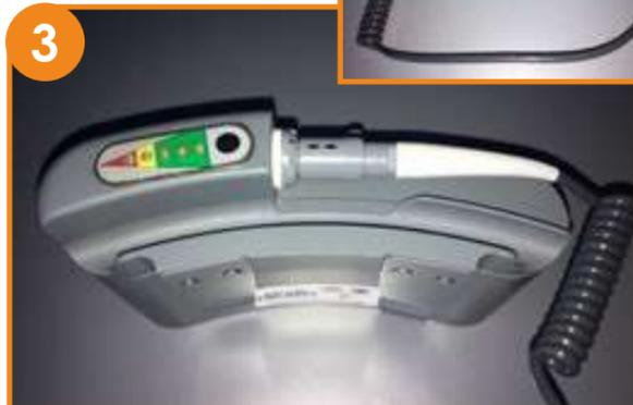
3 Prendre un câble simple et connecter l'embout gris et blanc à la batterie.
