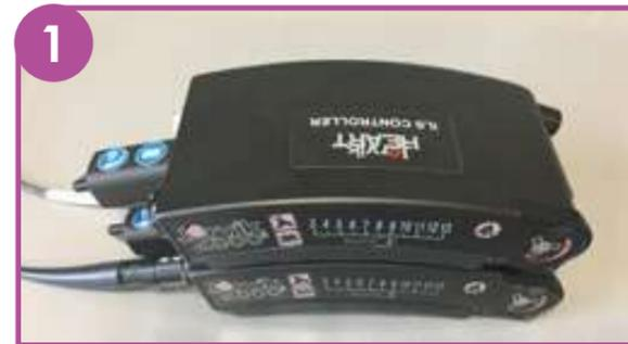
1 Placer le contrôleur de secours au dessus du contrôleur actif défectueux.
