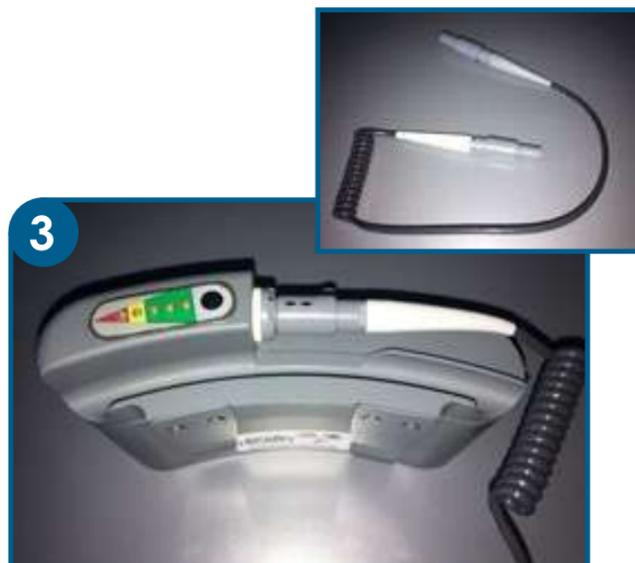
3 Prendre un câble simple et connecter l'embout gris et blanc à la batterie.
