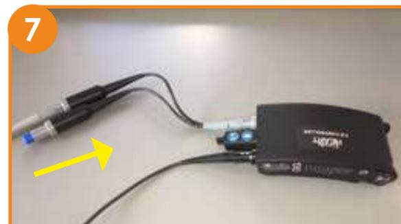
7 Adapter le bouchon bleu sur l'extrémité libre du câble en Y.
